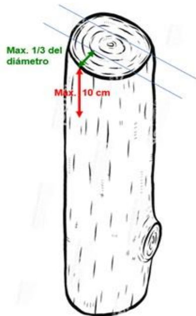
Figura 2. Ejemplo defectos NO tolerables - Deformación sinuosa del rollizo
